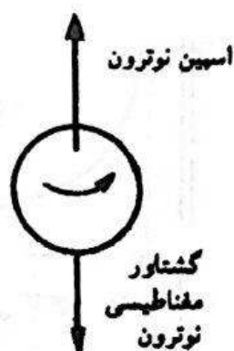
شکل ۲.۹ نمایش سمتگیریهای نسبی اسپین و گشتاور مغناطیسی نوترون
